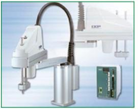
En esta ocasión, a estos robots, con precios a partir de 5.000€, se les ha añadido más rango en la longitud de brazo. A los robots IXP Scara con una longitud de brazo de 350mm y 450mm, se han sumado nuevos modelos de 180mm, 250mm, 550mm y 650mm. Estos dos últimos permiten una carga nominal de dos kilos y una carga máxima de hasta 6 kilos. Estos modelos de robot IXP Scara con motor paso a paso disponen, como estándar, de encóder absoluto sin batería.
