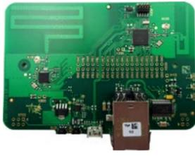
El gateway 6LoWPAN funciona como router fronterizo en las redes basadas en 6LoWPAN y conecta las redes inalámbricas basadas en IPv6 a Internet. Esta placa facilita los procedimientos de routing necesarios para integrar en la red IP global una red de malla de IPv6 que incluya pequeños dispositivos inalámbricos de baja potencia; además, permite a los usuarios conectar hasta 32 nodos secundarios de 6LoWPAN a la red.
