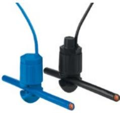
Las tomas de tensión están disponibles para secciones desde 2.5 mm<sup>2</sup> a 6 mm<sup>2</sup> y desde 10 mm<sup>2</sup> a 16 mm<sup>2</sup>. Asimismo, el circuito de tensión está previsto con un fusible integrado de 2A, que satisface la protección contra cortocircuito y sobretensión indicado en DIN VDE 0100.
