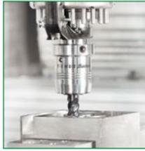
El portaherramientas de expansión hidráulica Schunk Tendo Aviation, combina las virtudes de la tecnología de expansión hidráulica con las de los montajes Weldon: sus características incluyen una precisión de tolerancias permanentemente alta, una óptima amortiguación de las vibraciones y cambios rápidos de la herramienta con una llave Allen. Incluso los trabajos con tolerancias exigentes, pueden mantenerse con una alta precisión.
