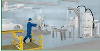
Este aplica un cordón adhesivo uniforme y supervisa mediante los sensores del cabezal de aplicación que su altura sea óptima. Cuando el robot ha finalizado su trabajo, entra de nuevo en acción el trabajador especializado, que encaja el depósito en la posición prevista de la carrocería del vehículo. El manipulador le apoya a la hora de ejecutar movimientos en condiciones ergonómicas desfavorables.
