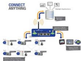
Nextfor ofrece una plataforma de conectividad de sensores inalámbricos para implementar redes IdC escalables en entornos remotos. Así, es posible conectar e integrar todos sus equipos para crear redes más inteligentes y eficientes. MQTT es un protocolo de mensajería sencillo creado para aplicaciones M2M e IdC a través de redes inalámbricas.
