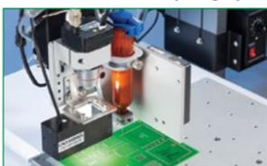
La Serie PRO4L incluye también sensores de altura láser totalmente integrados que detecta variaciones de altura sobre la superficie de un producto y hace correcciones en la altura de dosificación para impedir depósitos desparejos y daños a la punta o la pieza de trabajo. El software DispenseMotion guiado por visión avanzado de la Serie PRO simplifica la confi-
