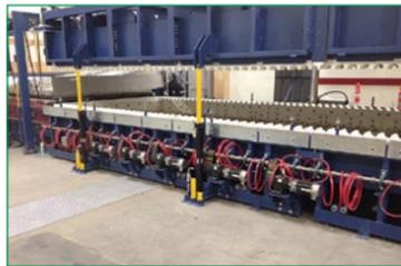
Un total de 14 unidades Unidrive M701 con SI-PROFIBUS están instaladas en los hornos de templado de vidrio de la empresa. Los rodillos transportan el vidrio a través de diversas secciones del horno, y luego a través de una sección de enfriamiento antes del envasado. Glaston también utiliza 14 servomotores brushless de alta dinámica (serie Unidmotor hd de Control Techniques), uno para cada unidad.
