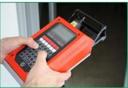
E-mark es una pistola de marcado "todo en uno". El cabezal de marcado, el teclado de programación y la batería que incorpora la convierten en un sistema de marcado único, que está sujeto a una solicitud de patente internacional. 100% portátil y autoalimentada
