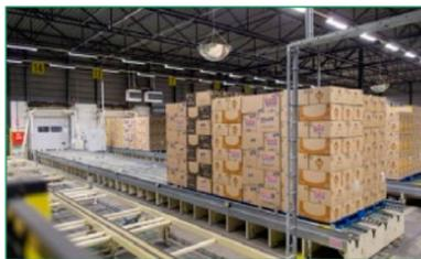
muelle como el semirremolque están equipados con un sistema de carriles, bajo los cuales hay instaladas mangueras de aire comprimido. Cuando no hay aire en las líneas, los carriles descienden ligeramente por debajo del nivel del suelo.
