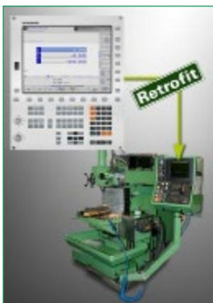
actuales. Estas modernizaciones son especialmente provechosas para máquinas con largos recorridos y una construcción robusta. En función de la máquina y del grado de modernización deseado, el cliente puede decidir con qué modelo actual de control numérico desea reconvertir la máquina. Para máquinas sencillas de 3 ejes se puede elegir entre el TNC 128 y el TNC 320. En máquinas complejas se recomienda una reconversión al control numérico actual de alta gama TNC 640.
