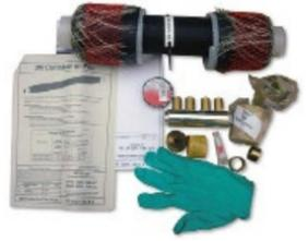
Este diseño de 3M ayuda a disminuir el espacio de aparcado del empalme y el tiempo de instalación gracias al pre-montaje desde fábrica del cuerpo del empalme, la pantalla de hilos y los tubos PST de EPDM para la reconstrucción de la cubierta del cable. El cierre de la cubierta también se efectúa con el sistema contráctil en frío, sin necesidad de herramientas ni esfuerzos adicionales.
