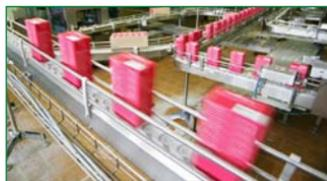
iwis ha desarrollado la nueva Flexon SafeTopChain para satisfacer altas exigencias. La cadena destaca por su diseño que ofrece una superficie completamente cerrada en las curvas. De esta manera la cadena reduce el peligro de aplastamiento en curvas y desviaciones y ofrece la mayor estabilidad para productos y sistemas portapiezas. La superficie cerrada permite transportar sin algún peligro las más pequeñas piezas.
