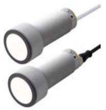
La nueva serie UA30CAD60 de Carlo Gavazzi se presenta en dos versiones, una con 2 salidas digitales NPN o PNP y otra con una salida analógica (4-20mA o de 0-10VCC) más una salida digital NPN o PNP. Las salidas digitales pueden seleccionarse como salida estándar con dos puntos de consigna, histéresis ajustable para funciones de llenado o vaciado o función de ventana. La salida analógica tiene pendiente positiva o negativa.
