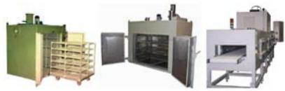
Bautermic ofrece hornos metálicos fabricados interiormente en hierro galvanizado hasta 350°C o en acero Inox
