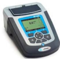
Hach Lange ha desarrollado un dispositivo portátil de nueva generación para analítica de aguas: el espectrofotómetro DR 1900. El DR 1900 combina la diversidad de parámetros con la precisión de la medición espectral in situ.
