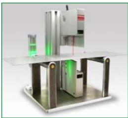
El innovador sistema de detección de doble chapa de Fegemu utiliza sensores láser clásicos que funcionan según el principio de triangulación. La configuración realizada por Roland Electronics utilizando los sensores mejor adaptados permite, por primera vez, una completa supervisión del proceso de medición.
