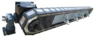
El indexador lineal TAKMAT tipo LF es de cadena rápida y preciso fabricado para ofrecer altas precisiones de indexado. El accionamiento de todo el conjunto se efectúa con un indexador rotativo estándar, pero también es posible el accionamiento con otros sistemas motorizados.
