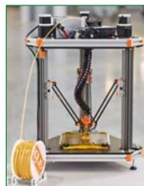
IguS ha presentado en la feria de Hanóver el primer tribofilamento para impresoras 3D del mundo. El material es ideal como material para puntos de apoyo, ya que es hasta cincuenta veces más resistente al desgaste que los materiales convencionales para impresión en 3D. Gracias a la combinación de la nueva tecnología de impresión y el tribofilamento de igus también es posible crear cojinetes deslizantes con formas especiales extraordinarias.
