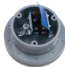
Estos controladores de nivel para líquidos se componen de un microinterruptor accionado por una membrana sensible a la presión. La conmutación del microinterruptor se obtiene por la compresión de la columna de aire que queda cautivo en el interior del tubo al ascender el líquido en el depósito.
