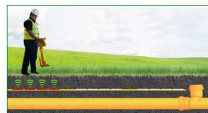
3M ha presentado novedades en su sistema de marcado electrónico RFID de 3M Track and Trace Solutions que, beneficiándose del uso de tecnología digital, ofrece una localización precisa de tuberías, cables y otras infraestructuras enterradas.
