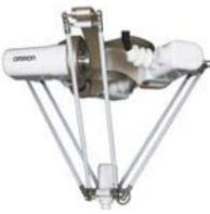
Dentro del abanico de soluciones "Pick and Place" que ofrece Omron citar la serie de robots DELTA IP67; añadá una solución Wahsdown idónea para el sector alimenticio y farmacéutico. Esta nueva serie se añade a la ya conocida gama de robots DELTA de Omron.
