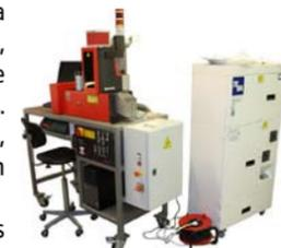
marcar a alta velocidad con bajos costes de funcionamiento y mantenimiento. Muy robusta, la máquina láser permite el marcaje sobre todos los materiales metálicos (acero, aluminio, acero inoxidable, titanio...) y la mayoría de piezas plásticas. La fuente láser es un láser de fibra dopada con Iterbio YB 20W.
