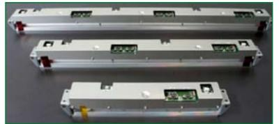
El nuevo sensor de visión por contacto (CIS por sus siglas en inglés Contact Imaging Sensors) Mitsubishi CIS serie KD ofrece una solución costo-eficiente para la inspección de superficies y objetos planos o casi planos. Con un sensor CMOS propietario tri-lineal a color y luz LED blanca integrada, materiales tipo tejido pueden escanearse en color y con una resolución de 600dpi.
