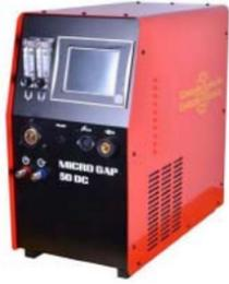
de proyecciones. • Menos evaporación del zinc. Como aplicaciones destacar: El rango de aplicaciones del sistema plasma abarca desde la soldadura de delgadas láminas fabricadas con metales no férricos así como trabajos de matricería de altísima calidad. El arco alcanza una gran penetración de la raíz y una deformación significativamente menor por efecto del calor. La elevada calidad obtenida de los cordones de soldadura, y la velocidad de trabajo son ventajas características de la soldadura.
