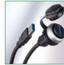
tan en orificios estándar de 22.5mm de diámetro. Están diseñados con tecnología Super Speed USB 3.0. Con forma A, son totalmente compatibles. Pueden transferir datos hasta 5 Gbits en un segundo, y están diseñados para una transferencia de datos total dúplex y una corriente de carga de hasta 900 mA. Además, en el caso de redes Ethernet, los MSDD están disponibles como modelos RJ45 (hembra/hembra), una solución perfecta.
