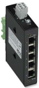
El Switch ECO de WAGO (852-1111) es ideal para redes de datos pequeñas y medianas, donde el foco principal es la usabilidad. No requiere preconfiguración. Conecta 5 dispositivos de red en una red de datos Ethernet con valores de transmisión de 10,100 ó 1000 Mbit/s. Las características del Switch ECO industrial son las estándar de un switch de red, como el ajuste automático de datos o el cable de detección automático de transmisión / recepción (Auto-MDIX).
