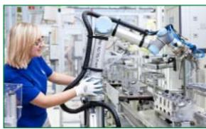
tenían que insertar las bujías desde una postura inclinada en el orificio roscado de las culatas poco visible.
