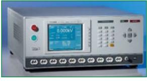
Instrumentos de Medida, S.L. presenta el nuevo modelo Chroma 19036, un comprobador de seguridad eléctrica para la industria que combina las funciones de test de impulsos, analizador de rigidez dieléctrica
