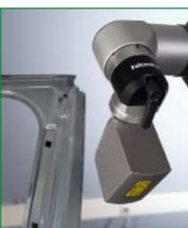
Para obtener los resultados de la medición de forma ágil y sencilla, el sensor tiene que integrarse adecuadamente en todo el sistema. El cabezal giratorio automático RDS-CAA es ideal porque sólo deben ser calibradas algunas posiciones individuales, aunque todas las posiciones angulares están disponibles para la aplicación.
