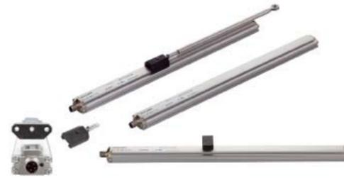
suciedad, en una carcasa de nivel IP 67. Gracias a la tecnología multiimán, los transductores sin contacto detectan fiablemente la posición de medida y aseguran unos resultados absolutos y precisos. Se pueden alcanzar unas longitudes de medida de 50 a 4570 mm; los sistemas de medida de posición toleran un desajuste vertical y horizontal del codificador de posición al perfil del sensor de hasta 15 mm.
