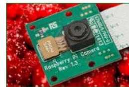
de 1.4 micras. Realiza fotografías de 5 megapíxeles, captura de vídeo de alta definición (HD) de 1080p/ (30fps) y velocidad de fotogramas de 720p/(60fps). El módulo de cámara comunica con Raspberry Pi a través del conector de cámara existente, utilizando CSI para los datos e I2C para el control. Esto permite a los usuarios grabar 30 fotogramas por segundo a 720p y 1080p en formato de video H264.
