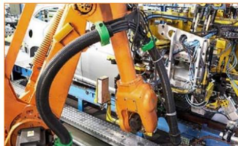
En Ford Alemania, la Borrmann Company ha equipado una línea de montaje de parachoques, tapas de maletero y capós con ocho cámaras inteligentes IVC-3D de SICK. Estas cámaras sirven para detectar exactamente las posiciones de atornillado empleadas posteriormente para guiar el robot de forma visual.
