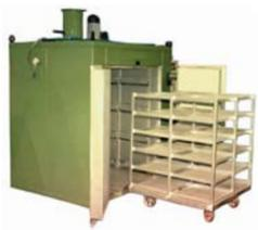
Se trata de estufas (hornos metálicos) previstas para poder cargar las piezas a tratar sobre carros, bandejas, palets, cajas, cestas... Se fabrican en distintos formatos y pueden ser calentadas eléctricamente o a combustión. Sirven para todo tipo de Calentamientos, Secados, Deshidrogenado, Revenido, Estabilizado, Dilatación,
