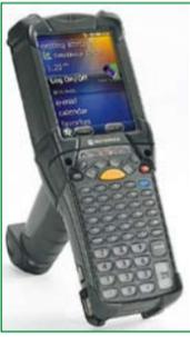
Diode, a través de su División de Identificación Automática, anuncia la disponibilidad del terminal gun-style MC9200, un modelo de próxima generación con empuñadura tipo pistola (gun-style) de la serie MC9000 de Motorola.
