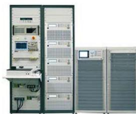
Para la batería, como parte más importante del vehículo eléctrico, Chroma desarrolla sistemas de test automáticos que integran la fuente de alimentación CC y la carga electrónica para los ensayos de carga y descarga, así como la simulación del consumo de batería del vehículo en ruta. La tecnología de reciclado de energía del
