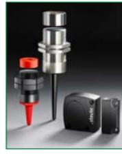
Está equipado con contactos tipo caña, mientras que los sensores cilíndricos inalámbricos RF GS M25 y RF GS M30 detectan el objetivo por el efecto GMR. Esto ofrece la ventaja a los usuarios de que el sensor se puede montar también en plantas y máquinas vibrantes dado que las vibraciones no pueden influenciar el efecto GMR.
