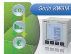
Sus características a destacar de la serie son: • Tensiones de entrada: hasta 500V (L-L), 289V (L-N). • Montaje a panel. • Puerto USB. • Medida de energía consumida y producida. • LCD de 4 líneas retroiluminado. • RS485 (Protocolo Modbus RTU/MEWTOCOL). • Alimentación en V AC / V DC. • Medida de corrientes de tan solo 1mA. • Se pueden medir hasta 3 circuitos (1P2L), (3P4L -> 1 circuito).
