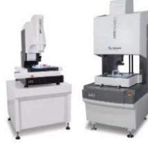
Hexagon Metrology suministra todos los modelos Optiv con el software de medición PC-DMIS Vision. PC-DMIS Vision ha sido especialmente diseñado para aparatos de medición ópticos y multisensor. Medición basada en características, funciones para la edición rápida de programas de medición y una amplia funcionalidad de procesamiento de imágenes son algunas de sus características.
