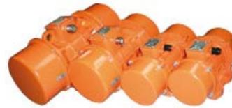
reunidos en ella. El motor eléctrico es asíncrono trifase o monofase y se construye con chapa magnética barnizada, estator impregnado de resina epoxi. Disponen de aislamiento en cueva clase F y aislamiento de hilos clase H.
