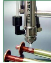
ValveMate™ y un tanque. El controlador es programado con el tiempo de dosificación y presión de aire requerido para obtener la cobertura necesaria. Para mantener el orificio de la boquilla limpio después de cada ciclo, el controlador cuenta con un aire programable de retraso. Esto permite reducir el mantenimiento y tiempo muerto. Sus características a destacar son:
