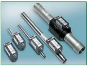
Los sensores de caudal utilizan el proceso de medición calorífico y registran las más ínfimas cantidades consumidas, a partir de los 0,06 Nm<sup>3</sup>/h. Así se consigue detectar precozmente el desgaste o los escapes en las instalaciones. Con el gran rango de medición de hasta 700,0 Nm<sup>3</sup>/h, estos aparatos también son adecuados para las mediciones de consumo en funcionamiento.
