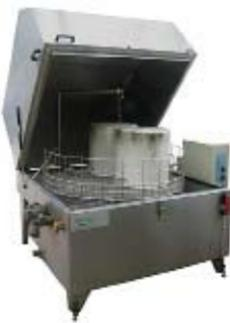
Las máquinas LIK-R de Bautermic S.A. permiten lavar, desengrasar y enjuagar piezas de diferentes dimensiones y con un alto grado de suciedad.
