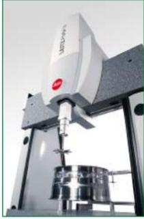
árboles de levas, así como a otras máquinas especiales. La elevada resolución de las barras de escala permite resultados de medición reproducibles. En la Leitz PMM-Xi llega a ser de 0,02 micras.
