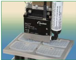
Los sistemas PicoDot de dispensación por Jet aportan, de forma significativa nuevas capacidades, a la extensa línea de sistemas de precisión para dispensación de fluidos. Puesto que los sistemas PicoDot no entran en contacto con el sustrato, facilitan a los fabricantes la colocación controlada de volúmenes de
