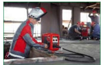
condiciones que imperan en el sector de la soldadura, la unidad es extremadamente robusta, resistente al impacto, gracias a su portabilidad y dimensiones compactas, se puede integrar fácilmente en el ambiente de trabajo cotidiano del soldador.
