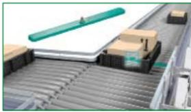
La nueva cabeza de lectura RFID de 54 centímetros tiene un rango de lectura continuo a lo largo de toda su longitud y una distancia de lectura uniforme de 65 mm. Se conecta al interface IDENT Control y soporta todos los buses industriales comunes. Trabaja con un sistema LF, es decir, puede funcionar incluso montado directamente sobre metal. La baja altura de sólo 15 mm es una ventaja, al igual que los orificios de montaje de la cabeza de lectura.
