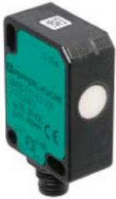
Una nueva generación de sensores de ultrasonidos en miniatura ha llegado. La serie F77 de Pepperl+Fuchs detecta objetos con precisión milimétrica. Incluso objetos transparentes o muy reflectantes se identifican de forma fiable, gracias al amplio cono de sonido y la alta frecuencia de conmutación de hasta 50 Hz.
