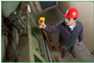
El Fluke 62 Max es ideal para un rápido análisis de la temperatura para localizar la evidencia de focos calientes, inusuales, fallos eléctricos y electromecánicos, hasta patrones indeseados de entrada y salida de aire en el conjunto del edificio.
