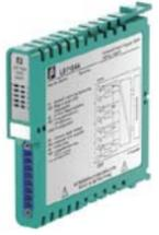
En función de los ajustes, el módulo universal de E/S LB7x04 procesa entradas y salidas analógicas y binarias. Su estado se visualiza por medio de LED y durante la instalación el módulo se puede configurar según las necesidades. Cuando se sustituye el módulo se adoptan de manera automática los ajustes anteriores.
