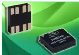
De montaje superficial (SMD), además ofrece metalización lateral, lo que permitirá procesos de reconocimiento automático de soldadura AOI (Visión óptica automática). Los pads tienen terminación en oro lo que garantiza una conectividad entre el componente y la circuitería de la PCB más segura y de mejor calidad.
