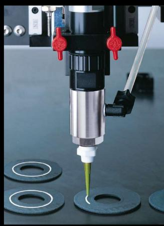
El sistema de dispensación con valvulas Nordson EFD de bajo mantenimiento, garantiza depósitos precisos y constantes de adhesivos, lubricantes, siliconas, pastas, ....
