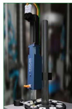
cortos. Una Unidad de Perfil complejo que logra una velocidad máxima de hasta 400 mm / s y una repetibilidad de desplazamiento de 0.002 mm.
