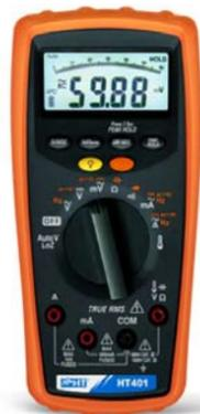
El instrumento está fabricado en acuerdo con la normativa de seguridad IEC/EN61010-1 con protección de doble aislamiento en CATIV 600V. Está dotado de un visualizador LCD con barra gráfica. Dispone de función Autoapagado para preservar la vida de la pila interna.
