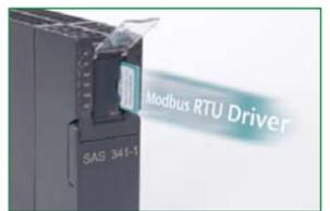
Con el dispositivo RS232 se pueden realizar conexiones punto a punto, con la versión RS485 se puede conectar hasta 32 usuarios en modo medio dúplex 2-hilos. En comunicación con sistemas remotos las funcionalidades Modbus RTU códigos 01, 02, 03, 04, 05, 06, 07, 08, 11, 12, 15 y 16 son soportados. La transferencia de datos al PLC S7 es realizada por bloques con los function blocks incluidos en la entrega.
