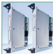
Los amplificadores son idóneos para una gran variedad de dimensiones físicas y permiten una cuota de exploración máxima de 250 kSps por canal con una resolución de 24 bits. Además, trabajan con entradas diferenciales y son compatibles con TEDS (hojas electrónicas de características del transductor) e IEPE (electrónica piezoeléctrica integrada) para transductores piezoeléctricos.
