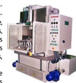
aclarado, pasivado, fosfatado, secado, etc... Todo ello en la misma máquina con diferentes ciclos o etapas, sin necesidad de tener que manipular las piezas durante los procesos intermedios.
