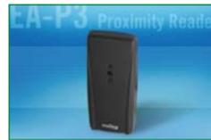
El controlador de proximidad, compacto y de perfil bajo, presenta un diseño con aislamiento y resistente a las inclemencias del tiempo. Puede combinarse con el lector de Pin/Proximidad EA-P1 para tener un sistema de control de accesos completo. Su LED integrado proporciona información visual sobre la aceptación de la tarjeta, y además trabaja con cualquier sistema de control o seguridad mediante sistema Wiegand a 26 bit. El controlador EA-P3 es fácil de instalar, configurarse y funcionar.
