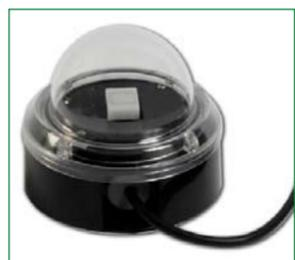
El sensor dispone de un fotodiodo de alta precisión, con un filtro y un difusor exclusivos, que mide la iluminancia con una curva similar a la del ojo humano. Posee un rango de medida de 0 a 50.000 Lux, con una precisión que se ajusta automáticamente y permite garantizar una resolución de 0,1 a 13,5 lux, en función de la escala.
