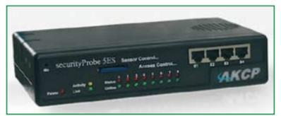
dotado del sistema operativo Linuxc. Dispone de 8 entradas para transductores de distintos parámetros físicos y eléctricos tales como temperatura, humedad, humo, caudal de aire, potencia/consumo eléctricos, presencia de agua, etc, a los que se puede definir hasta cuatro umbrales alto/bajo para notificación y alarma.
