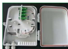
Esta novedosa caja terminal o de distribución permite alojar, en compartimentos diferenciados, los acopladores y los empalmes correspondientes a un máximo de dieciséis conectorizaciones tipo SC y un splitter 1x8 o 1x16.
