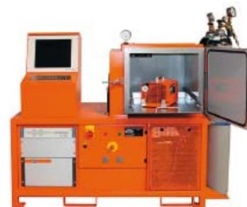
aire ambiente, el resultado de la prueba es de alta precisión y garantizada. La nueva unidad de prueba de fugas prácticamente hace un "trabajo detectivesco", ya que es capaz de rastrear las más pequeñas fugas de SF6. Incluso valores de fuga de hasta 1\* 10-9 mbar l / s se pueden detectar fácilmente.
