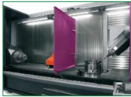
El resultado de esta integración de procesos se presentará en la feria en el centro de mecanizado ZVH45/L4000 MULTIPROCESS, con recorridos X = 4.000 mm; Y = 800 mm y Z = 900 mm. Esta máquina incorpora un electrohusillo especial para fresado y torneado con 12000 rpm.
