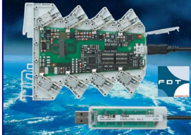
Parametrizable mediante interfaz FDT o con "switches" sin apertura de carcasa
