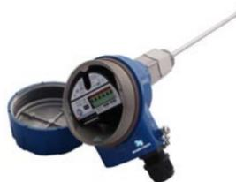
Los impulsos por microondas generados por la electrónica y de alta frecuencia son guiados a lo largo de una sonda conductiva, que está sumergida dentro del producto. Si los impulsos llegan a la superficie del líquido o polvo, partes de la energía de los impulsos son reflejados a través de la sonda. La electrónica calcula el nivel del producto por medio de la diferencia del tiempo entre los impulsos enviados y reflejados.
