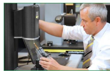
entrada o el aseguramiento de calidad. La estructura básica del aparato, de carbono, posibilita un uso móvil: en tan solo cinco minutos el instrumento está armado y listo para usar. Además de movilidad, la tecnología de carbono posibilita una gran rigidez –la condición básica
