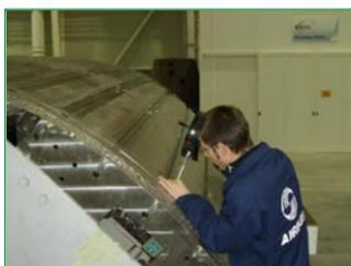
Los equipos de la División de Metrología de Leica Geosystems son herramientas esenciales para poder garantizar la calidad del producto en las diferentes unidades de EADS. Estos equipos se utilizan frecuentemente en los procesos de fabricación, verificación y certificación de las herramientas y utillaje de producción y de las piezas permitiendo un ensamblaje verificado mediante procesos metrologógicos.
