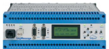
Los Data Loggers LogMessage tienen 1GB de memoria interna para registro de hasta 128 millones de datos. Su interface Ethernet permite la conexión a la red LAN para configurar, monitorizar, analizar o descargar datos. Disponen también de 2 puertos serie configurables para conectar otros dispositivos o modems. Dispone de pantalla para supervisión del equipo y las medidas. Se alimentan entre 12 y 36 Vcc.
