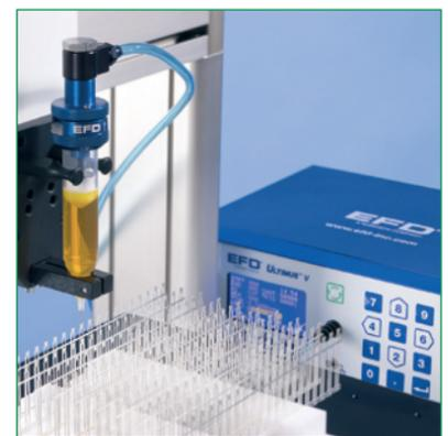
El dosificador de alta precisión Ultimus V es una nueva forma de manejar los cambios de viscosidad de los fluidos. Epoxies de plata, epoxies de fijación de obleas ("die-attach") y materiales para undefill son utilizados en electrónica y en otras aplicaciones de ensamblaje en la producción. Al cambiar su viscosidad con el tiempo estos fluidos suponen un desafío único. Como estos materiales comienzan a ponerse más viscosos lo largo de su vida útil, el tamaño de la aplicación se hace más pequeño.
