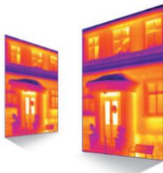
aprovechan en el momento de la captura de la imagen. Las cámaras termográficas Testo utilizan la serie imágenes capturadas integrándolas con un algoritmo y creando una termografía 4 veces mayor.
