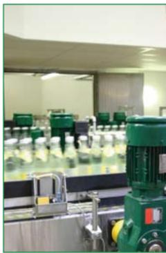
Los sistemas de envasado, paletizado y tecnología de transporte de BMS emplean tecnología mecánica y electrónica de accionamiento de NORD. Los conceptos de sistema descentralizado han sido implementados con el trío compacto SK 300E, la combinación de un motorreductor y un convertidor de frecuencia
