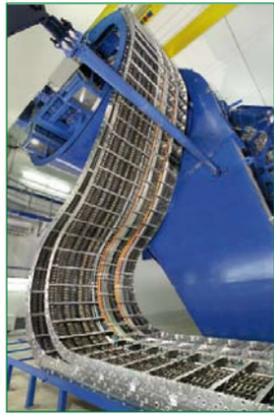
Uno de ellos es el puente grúa, el sistema de guiado de alta precisión del haz rotativo de iones pesados: este coloso tiene tres pisos de alto y un peso total de 670 toneladas; 600 de las cuales son móviles. KABELSCHLEPP suministró una solución ahorradora de espacio con dos cadenas portables de acero, una dentro de la otra, combinadas con un radio de curvatura invertido. El pórtico funciona ahora con una
