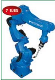
se instala el cableado, se eliminan posibles interferencias con la pieza de trabajo, el utillaje u otros robots. La innovación de los 7 ejes ha aumentado drásticamente la libertad de movimiento del robot y adopta la postura óptima en todo momento, simplificando la programación y reduciendo el desgaste del cableado. El robot VA1400 se caracteriza por tener una repetibilidad de ±0.08 mm, un alcance máximo de 1434 mm y 3 Kg de carga útil que mejora el incremento de la productividad.
