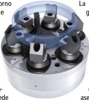
La lubricación permanente integrada, garantiza una fuerza de sujeción constante en el cierre y, por lo tanto a un gran nivel de eficiencia. Gracias a que está herméticamente cerrado, queda en gran parte libre de mantenimiento. Todas sus piezas funcionales están templadas y rectificadas, lo cual prolonga la vida útil de la herramienta. Además, este plato es de una altura reducida, lo cual también asegura el suficiente espacio en la zona de trabajo de la máquina.
