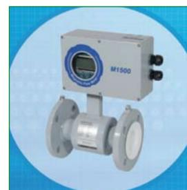
El dispositivo puede preconfigurarse desde fábrica para sólo ser conectada in situ, se ubica en una carcasa troquelada de aluminio con revestimiento IP65 y cuenta con dos tornillos M 20. Puede suministrarse con una pantalla de LCD con cuatro líneas, alimentación eléctrica 115/230 VAC así como con salidas analógica y de pulso activo.
