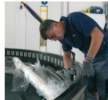
un rodamiento especial de NKE. El rodamiento de rodillos cilíndricos de diseño especial con jaula maciza en acero tiene un diámetro exterior de 3,3 m, un diámetro interior de 2,9 m y un peso de 2,2 toneladas.
