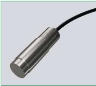
Cuenta con diseño completamente hermético que cumple los estándares IP 68/69K. Tanto el frontal como la superficie exterior son de acero inoxidable (Grado: 1.4404 (V4A, AISI 316L)). Cuentan con rango de detección totalmente ajustable de 200 a 3000mm. Modelos con salida analógica y punto de ajuste configurables. Cumple las directrices EHEDG (European Hygienic Engineering & Design Group) "Diseño Higiénico".
