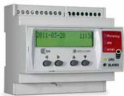
Efficiency Data Server es un dispositivo dotado de un PowerStudio Embedded con servidor Web integrado, que facilita al usuario la consulta de cualquier variable sin necesidad de instalar software alguno en un ordenador en la red de área local. Dispone además de 4 entradas digitales libres de tensión y 4 salidas por relé programables.
