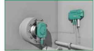
Los controladores de conmutación de levas se utilizan allí donde el control se realiza en función de la posición de la máquina. Con los controladores de levas mecánicas, y particularmente con los movimientos de rotación, las levas mecánicas se colocan en un eje. Dependiendo de las características de conmutación de la aplicación estas levas deben colocarse de forma intrincada para activar los interruptores mecánicos.
