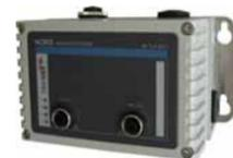
El módulo de bus puede montarse directamente en la unidad de interfaz del SK 200E o separado del variador mediante un kit opcional para montar en la pared. La línea de bus EtherCAT se conecta a la caja de la unidad mediante un conector M12. Además, la caja integra ocho entradas de 24 V y dos salidas de 24 V.
