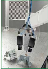
VisionPro 3D utiliza múltiples conjuntos de características en dos dimensiones detectadas por las probadas herramientas de alineación de Cognex, que incluyen PatMax, PatFlex™ y otras herramientas de correspondencia de patrones geométricos. Estas herramientas funcionan con iluminación no uniforme y son confiables incluso cuando los patrones están parcialmente cubiertos, lo que garantiza la localización precisa de piezas en las condiciones más exigentes.
