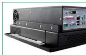
La familia DuraFLEX consta de DuraPC, DuraMON y DuraPANEL. DuraPC es un PC en una caja negra compacta y robusta, con los procesadores móviles, usando la cubierta única de ISIC y su tecnología de gestión de calor.
