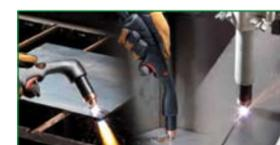
La nueva antorcha recta, diseñada para corte manual, permite cortar y acanalar fácilmente en lugares de difícil acceso. Se trata de la primera antorcha recta de mano disponible para los sistemas Powermax1000, Powermax1250 y Powermax1650 de Hypertherm.
