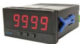
Fema electrónica presenta el indicador de panel para medida en TrueRMS (Verdadero Valor Eficaz) de voltajes y corrientes en AC. Con categoría de medida CAT-III hasta 300Vac y CAT-II hasta 600Vac, cuenta con medida de corrientes hasta 5Aac y acoplamiento seleccionable en "AC" o "AC+DC".
