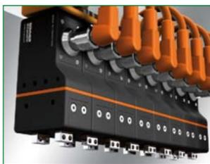
Esta pinza está libre de mantenimiento hasta 30 millones de ciclos, con un guiado robusto de larga vida útil. La transmisión de fuera se realiza a través de palanca acodada de acero nitrurado a gas, con guía cilíndrica y con mordazas de duro aluminio anodizado duro. La protección contra suciedad evita la entrada a partículas >0,1 mm.
