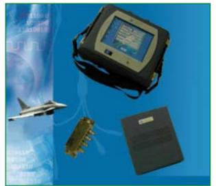
El equipo de prueba desarrollado por AXON' comprueba sucesivamente todas las líneas Stub del mazo y en particular las siguientes características eléctricas: atenuación, polaridad (fase), resistencia del transformador, presencia de un cortocircuito entre los pares y la malla de apantallamiento.
