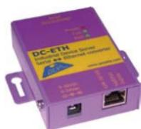
DATA-CONTROL PC, empresa especializada en el diseño y fabricación de equipos electrónicos, presenta el nuevo device server DC-ETH, un convertidor de RS232/RS485 a Ethernet.
