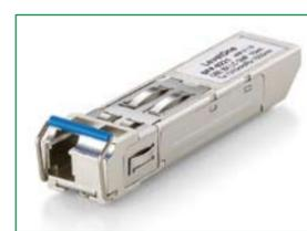
Este modelo monomodo transmite usando una longitud de onda de 1310 nm y recibe mediante una longitud de onda de 1550 nm. Además, en combinación con los transceptores SFP-9231 de LevelOne, que operan a frecuencias opuestas (1550 nm RX y 1310 nm RX), el SFP-9221 dota de una comunicación de datos bidireccional con mayor capacidad en un solo cable de fibra.
