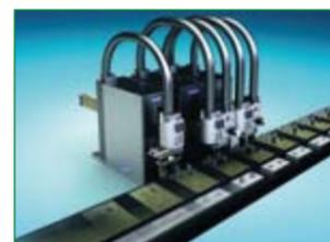
Schunk presenta la unidad Pick&Place PPU-E03. Esta dinámica unidad tiene una carrera vertical de 40 mm, una carrera horizontal de 120 mm, así como una capacidad de carga en movimiento de dos kilos, con un tiempo de ciclo de tan sólo 0,58 segundos y con una excelente repetibilidad, hasta 0,01 mm. Actualmente no existe ninguna unidad más en todo el mundo que pueda llegar a tales velocidades.
