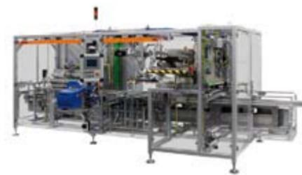
LoeschPach, representada en España por Comercial Schneider, S.A., presenta en la Feria Interpack de Düsseldorf (Alemania) la nueva estuchadora modular modelo LRK con robot de alto rendimiento para formar, llenar y cerrar estuches de cartón y expositores mediante Top Loading para diferentes distribuciones de productos, incluso adecuada para productos delicados y difíciles de apilar, por ejemplo aquellos envueltos en pillow-pack.
