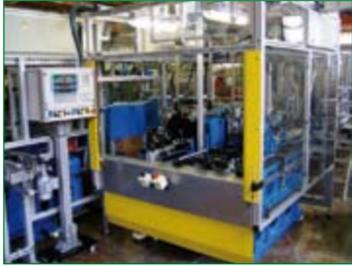
Esta línea de ensamblaje está compuesta por 3 módulos automáticos donde se ensamblan guías de asientos de coche. Para realizar el montaje estos módulos tienen, entre otros componentes, alimentadores automáticos de piezas, unidades de ensamblaje, sistemas de aplicación de grasa, marcadoras y unidades de control y posicionamiento de piezas. Los procesos que se llevan a cabo en estos módulos
