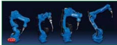
Los robots de soldadura al arco de la serie MA cuentan con radios de trabajo desde los 1434mm hasta los 1904mm y una carga en la muñeca desde los 3 Kg. hasta los 15 Kg. La gama de robots de 6 ejes MA1400, MA1800 y MA1900, mejoran significativamente la calidad de la soldadura.
