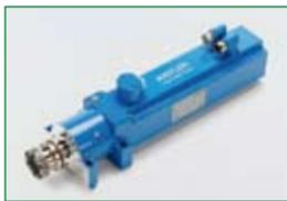
Los módulos Joining System NC electromecánicos NCFH, tipo 2151B más pequeños -de tamaño 1- están disponibles con fuerzas nominales de 10 y 15 kN, y en varias combinaciones de rango de medida desde 1 kN hasta 15 kN. El tamaño 2 cubre fuerzas de 30 y 60 kN, y rangos de medida de 15, 30 y 60 kN.
