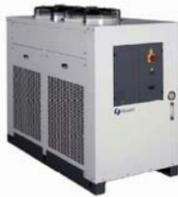
En determinadas aplicaciones las necesidades de temperatura para el fluido de trabajo sobrepasan los límites de las construcciones estándar. El nuevo rango de refrigeradores Olaer LCW, para bajas temperaturas de fluido, está concebido para llevar el fluido de trabajo, agua con etileno glicol al 50%, hasta los -30°C. La gama se compone de seis modelos, con potencias de refrigeración de 2,2 Kw a 20,9 Kw, en tres tamaños de fabricación.
