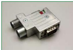
Los conectores Sub-D 9 Profibus de Murrelektronik disponen de dos conectores M12 codificados B para cables Profibus. La instalación es inmediata, los conectores se enchufan al conector de 9 polos Sub-D del esclavo, los cables de bus de campo a través de cables preconfeccionados M12 al conector de bus. Así se evita el costoso confeccionado del cable y la crítica conexión del cable apantallado al conector Profibus. Además las conexiones M12 garantizan una mínima carga durante el contacto.
