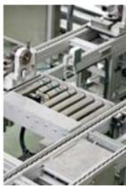
Minitec presenta el sistema flexible de montaje FMS, realizado con perfil estructural de aluminio anodizado. Diseño, montaje y puesta en marcha en un tiempo mínimo gracias a su concepción modular. Permite la construcción de sistemas completos de transporte de palets portapiezas entre estaciones de trabajo. Se pueden combinar tramos de banda y/o cadena, transferencias, discos de giro y ascensores/
