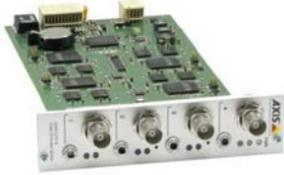
Axis Communications anuncia un nuevo codificador de vídeo en tarjeta con soporte H.264 de alto rendimiento, con posibilidad de configurar múltiples secuencias de vídeo y con audio bi-direccional en cada uno de sus cuatro canales. El nuevo codificador de vídeo AXIS Q7414 permite integrar cámaras analógicas en avanzados sistemas de vídeo vigilancia basados en IP.
