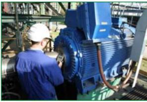
Sus ingenieros se desplazan a las instalaciones y realizan in-situ las medidas necesarias para poder establecer el estado actual de su motor/generador eléctrico. Las medidas son no invasivas, no interfieren en el funcionamiento habitual de su sistema de producción.
