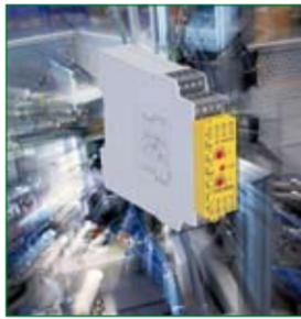
La frecuencia límite a controlar es ajustable entre 0.1 y 99 Hz. Se coloca a través de dos conmutadores rotatorios y se guarda de forma permanente en el dispositivo a través de un proceso de configuración muy sencillo. El dispositivo tiene además entradas para la conexión de un inhibidor de reset y "start override".
