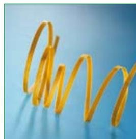
En principio, este cable plano extruido ha sido concebido para un sistema de dirección por hilo. El cable realiza la conexión entre el sensor de movimiento y el sistema de dirección. Integrado en un contactor giratorio, el cable está sometido a los movimientos circulares del volante y a consecuencia, a numerosas flexiones. Probado a 1.5 millones de ciclos de flexión, de los cuales un 30% a una temperatura de 125°C, este cable plano garantiza una larga vida de funcionamiento.
