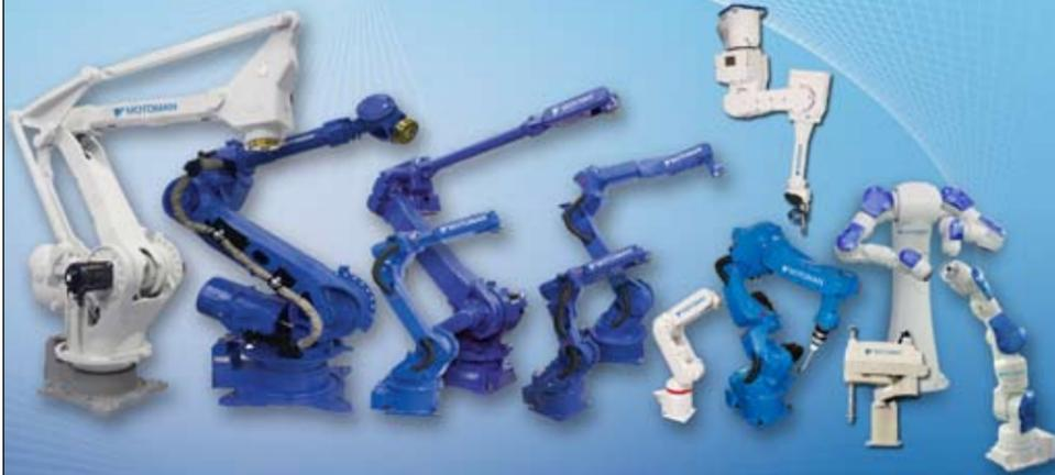
Amplia gama de robots para aplicaciones de soldadura, corte, sellado, paletizado, manipulación, montaje, ensamblaje, mecanizado, plegado y pintura, con cargas útiles de 3 a 800 kg.
