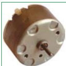
El motor solar C-6060, ideado y desarrollado por Cebek, entrega una potencia de salida de 0,23 W, con un par de giro de 10 g cm. Su tensión nominal es de 3 V y sorprende por su amplio margen de tensiones de trabajo, que oscilan entre los 1,5 y los 12 V. La velocidad del C-6060 sin carga es de 2.700 rpm,
