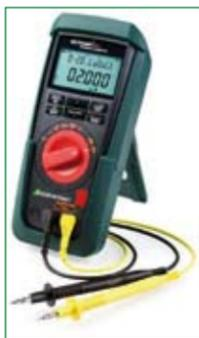
El nuevo calibrador METRAHIT CAL que presenta KAINOS de la firma GOSSEN-METRAWATT permite generar y simular una serie de parámetros electrónicos, incluyendo 10 termopares y 4 sensores de termoresistencia.
