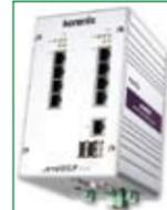
Se trata de routers embedded gigabit layer 3, con 4 puertos 10/100 (opcionalmente PoE) y 4 puertos Gigabit Ethernet que pueden proporcionar grandes anchos de banda para conexiones en red de ámbito industrial. Al tener plena capacidad routing en layer 3 y funcionalidades VPN, los productos JetBox-9300 y JetBox-9500, aportan nuevas posibilidades en el diseño de redes industriales, expandiendo así las posibilidades
