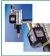
La unidad Backpack se monta sobre el cilindro neumático de la válvula de dispensación, manteniendo constante la presión de aire en la entrada y eliminando el riesgo de variación en el proceso a causa de las fluctuaciones en la alimentación neumática o a las diferencias de longitud en las tuberías de alimentación de aire. La unidad Backpack emplea una tecnología miniatura, basada en una electroválvula que per-
