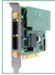
Xacom Comunicaciones presenta la placa PCI-GSM Xacom, desarrollada por la prestigiosa firma Comsat. Esta placa, permite adaptar una centralita IP con conectividad PCI a la red GSM con el objetivo de abaratar costes en las llamadas a la vez que se mejora el control de los mismos. La placa PCI GSM Xacom está diseñada para el sistema operativo Linux OS y ofrece, aparte de un controlador independiente para el kernel, un controlador de canal para Asterisk, que ya está incluido en el paquete.
