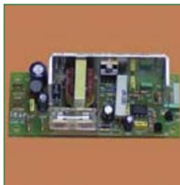
Icar presenta el elevador CC/CC conmutado baja corriente DC/DC 192/XX. Este convertidor conmutado de alta frecuencia cuenta con máxima corriente de salida, tensión de salida 24V 2A o 48V 1A DC/DC 192/24 2ª, protección contra: DC/DC 192/48 1ª y sobrecarga por limitación de corriente. Presenta un rendimiento a máxima potencia >85%, entradas y salidas por faston de 6,3mm e inversión de polaridad de entrada. Sus medidas son 1n2x40x35mm.
