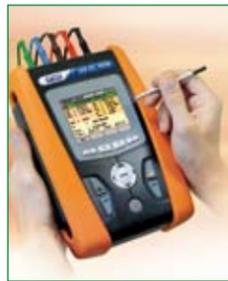
HT Instruments presenta el nuevo SOLAR300N, que permite la ejecución de todas las pruebas aconsejadas para la verificación de la eficiencia de las instalaciones fotovoltaicas monofásicas y trifásicas.
