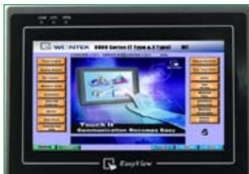
CT Automatismos y Procesos, S.L. presenta la serie 8000 de pantallas táctiles de la marca Easyview fabricada por Weintek. Las HMI de la serie 8000 se presentan en tamaños desde 7 hasta 15", con 65536 colores con resoluciones de hasta 1024 x 768 e iluminación por LEDs (máxima durabilidad y brillantez).
