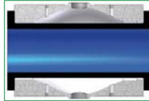
La válvula de aislamiento de explosiones EIPV de FIKE en combinación con otros componentes del sistema de protección de FIKE, ha sido diseñada para evitar la propagación de explosiones entre los equipos de proceso interconectados.
