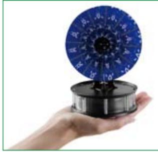
Fadisel nos sorprende con la presentación de su nuevo kit educativo para enseñanza, un motor que se activa por el calor de la propia mano. El motor C-7002 de Fadisel se activa mediante el calor desprendido por una simple mano. Este motor Stirling funciona mediante la expansión y contracción del aire. De esta manera, no necesita ni fuego, ni electricidad, ni combustible para su funcionamiento.
