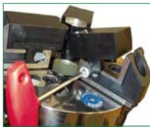
Hay razones de sobra para adoptar el sistema: tiempos más cortos para cambiar las garras, manejo más fácil y amplio margen de amarre. Todo en conjunto nos permitirá equipar de forma rápida y con una precisión muy alta - 0,02 mm. Tenemos la posibilidad de suministrar los anclajes de cambio rápido según las necesidades del fabricante en los tamaños estándares 160/200/250.
