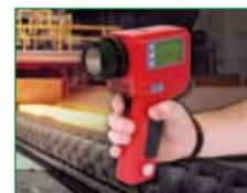
muestra también en el visor. El sistema óptico reflex de precisión proporciona un campo de visión estrecho (180:1, 98% de energía), permitiendo definir claramente la medida a altas temperaturas de objetos tan pequeños como 4.8mm a 1m de distancia.
