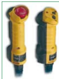
El nuevo mando de validación Omron A4EG permite al personal autorizado realizar operaciones de ajuste, programación y mantenimiento en zonas de riesgo de la máquina con la mayor seguridad. El interruptor "de hombre muerto" dispone de tres posiciones, de tal manera que la salida sólo se habilita cuando se mantiene pulsado en la posición intermedia; si se suelta o pulsa totalmente (situaciones de pánico), las salidas de seguridad se disparan.
