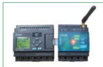
Disponible con alimentación a 12-24Vcc ó 85-256Vca en versiones 8 o 12 entradas analógicas o digitales en tensión de alimentación con opción de conteo rápido hasta 1KHz, además de 4 ó 6 salidas digitales con opción de dos de las salidas de control PWM o analógicas y hasta 2 bloques PID internos. Entre sus aplicaciones se encuentran: la automatización de maquinaria, cuadros eléctricos, seguidores solares, etc.
