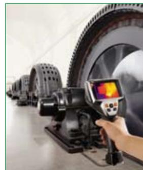
de la imagen IR del visualizador. En el mantenimiento preventivo industrial, la tecnología infrarroja garantiza el reconocimiento prematuro de posibles daños en componentes importantes de cualquier sistema de procesos. En el mantenimiento eléctrico, la termografía evalúa el grado de desgaste de los componentes en sistemas de baja, media y alta tensión y detecta fallos y conexiones defectuosas, minimizando el riesgo y costes en paradas.
