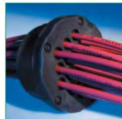
ción, una hermeticidad muy elevada y un tipo de estanqueidad IP 65 según normas EN 60529. En caso de que el grosor de la chapa del armario sea superior a 2,1 mm o inferior a 1,6mm, se puede poner una contratuerca. Existen actualmente 6 tipos de placas KDP/R de plástico: 3 de ellos son de métrica 50 (con diámetros de cables comprendidos entre 3 y 15,9 mm) y otras 3 de métrica 63 (con diámetros de cables comprendidos entre 3 y 15,9 mm).
