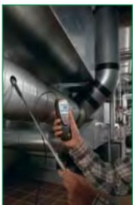
El área del conducto se puede configurar convenientemente en el instrumento. El cálculo del promedio por tiempo y multipunto proporciona información acerca del caudal promedio. También se pueden mostrar en el visualizador los valores máximos/mínimos. La función Hold permite fijar en el visualizador los valores actuales de medición. Para las mediciones en condiciones de baja visibilidad, el visualizador dispone de iluminación.
