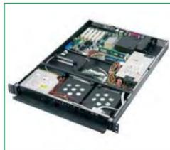
zan: alimentación, temperatura interna, ventiladores, HDD SATA y 2 LANs. Otra característica importante por la que destacan estos equipos es que, debido a la reducción de la temperatura interior del chasis, se ha diseñado un sistema de evacuación de
