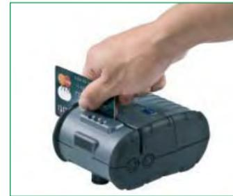
nuevos modelos pueden llevarse sujetos al cuerpo cómodamente durante toda la jornada de trabajo mediante un completo juego de accesorios y cinturones. Igualmente Intermec ha diseñado una carcasa con grado de estanqueidad IP-54 que protege las impresoras en las condiciones exteriores más adversas (lluvia, golpes y caídas), así como en las aplicaciones más exigentes (reparto de paquetería, distribución alimentaria, transporte, etc.).
