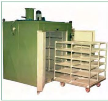
Por otra parte se resalta entre sus principales características, que ofrece un aislamiento de fibra, que sirve para reducir las pérdidas por radiación y de esta forma poder elevar su rendimiento térmico.
