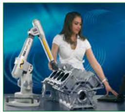
totalmente independiente de la red, el cual ofrece una gran autonomía. Su programa de aplicación ha sido desarrollado para un análisis rápido de los resultados y permite crear programas simplificados de medida. Contiene un volumen de medida de 1,2 m. Este medidor de 6 ejes completa el programa TESA,
