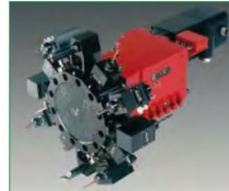
de accionamiento directo de herramienta, puede estar seguro de que el disco, motor y los componentes del accionamiento forman un sistema estanco protegidos de influencias externas. Esta torreta puede ser fácilmente incorporada al diseño de su torno. El sistema de herramientas integrado proporciona una excepcional estabilidad y mejorada transmisión de potencia.
