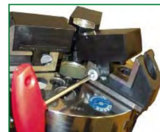
Tiempos más cortos para cambiar las garras, manejo más fácil y amplio margen de amarre. Todo en conjunto nos permitirá equipar de forma rápida y con una precisión muy alta 0,02 mm. Entre sus características más importantes destacan, su facilidad de cambio de las garras simplemente con deslizarlas hacia arriba, se pueden cambiar sin necesidad de quitar la base fija de plato fijo-anclaje, sistema de bloqueo incorporado para prevenir pérdida de sujeción, etc.
