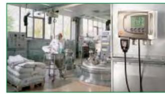
los materiales y componentes sensibles a la humedad se almacenan durante cortos periodos de tiempo entre los pasos individuales del proceso. La tecnología de sistemas de almacenado de aire seco inyectado o nitrógeno se usa para productos cuya humedad ambiental máxima en el entorno se debe situar entre el 3 y el 10 %HR. Dependiendo del tamaño del sistema de almacenado este se deshumidifica con nitrógeno o aire seco o la combinación de ambos.
