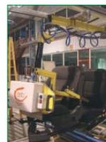
El sistema de manipulador neumático de transferencia de asientos diseñado por ASTI, realiza los siguientes movimientos:
