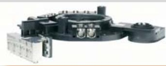
Al cuerpo base, que incluye el mecanismo de enclavamiento, se puede añadir todo tipo de módulos de transmisión eléctrica, neumática, taladrina, etc. Los módulos están estandarizados y pueden ser anclados, o intercambiados, en el cuerpo base del cambiador, incluso cuando éste está enclavado.
