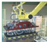
Otros ejemplos de soluciones específicas de AR son los manipuladores industriales (manipulación de planchas, sacos, botes, piedras, etc), las centrales de vacío especiales y las ventosas a medida.
