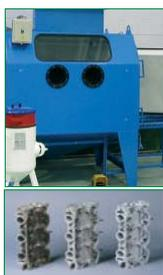
En éstas cabinas el polvo que se crea proviene de la propia pieza que se limpia y nunca origina problemas de visibilidad ni de colmatación de filtros. En las aplicaciones de chorreado con productos muy pulverulentos normalmente el filtro es una unidad separada cuyo rendimiento se potencia con la ayuda de
