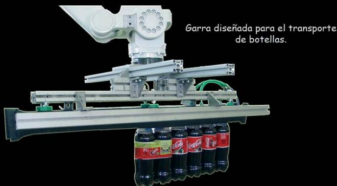
Garra diseñada para el transporte de botellas.
