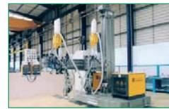
Asimismo ofrece entre sus productos, los equipos automáticos de soldadura, entre los que se encuentran, las columnas de soldadura, los posicionadores manuales, los posicionadores
