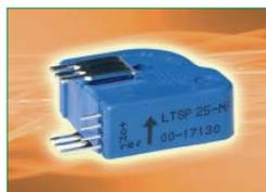
LEM ha introducido una novedad en su gama LTS de transductores de corriente diseñados para trabajar a partir de una fuente de alimentación única de +5V. El modelo LTSP mide corrientes positivas y negativas de CA, CC y pulsos en placas de circuito impreso y suministra una salida de corriente en lugar de la salida de tensión suministrada por otros modelos de la misma familia. Esto permite que el LTSP detecte corrientes de hasta, por lo menos, 14 veces la corriente nominal.
