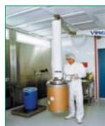
Sus múltiples sistemas permiten manejar cargas sin peligro de que estas caigan, aún cuando se de una repentina falta de fluido eléctrico en la red. Así mismo puede ser aplicado a una gran gama de tipos de cargas. Los manipuladores TROMPEX se emplean en todos los sectores industriales. Especialmente existe una gama para el sector farmacéutico, alimentario, etc., con acabados en acero inoxidable AISI304 o AISI316.
