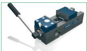
La BB 125 (garra con anchura 125mm) permite fijar piezas de hasta 208mm con una fuerza de 40000N. Con las mordazas TANDEM se ofrece un producto de máxima calidad, con la garantía SCHUNK.
