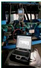
Si se registran las presiones y temperaturas durante un largo periodo de tiempo no resulta necesario vigilar el sistema durante muchas horas seguidas. Dichos registros se analizan mucho más rápidamente en un PC. Los analizadores de refrigeración testo 556 y testo 560 registran todas las lecturas de forma fiable. Su capacidad de memoria es de 60.000 lecturas y son capaces de registrar largas series de mediciones durante varios días sin ningún tipo de problema.
