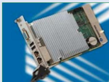
Diseñada con procesador Intel Core Duo de 1.2 GHz, bus front side de 533 MHz y una memoria DDR2-SDRAM ampliable de hasta 4 GB, especial para trabajar en las condiciones ambientales más severas alcanzando niveles inigualables de rendimiento, también posee dos puertos Gigabit Ethernet, y hasta seis puertos USB 2.0, dos interfaces SATA y un slot Compact Flash para un almacenamiento de hasta 8 GB.
