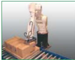
La principal novedad de este nuevo concepto es la integración de todos los elementos de la célula sobre una referencia común, por lo que su montaje es muy sencillo, pudiéndose incluso realizar por el propio cliente final sin la intervención de personal técnico de Inser Robótica. De este modo, este tipo de células compactas pueden ser suministradas "en caja" para que sea el propio cliente final el que la instale y la ponga en marcha siguiendo los pasos descritos
