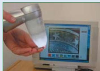
Se conecta directamente al puerto USB y posee luz interna para su uso en contacto con la pieza. Guarda la información en formatos estándar de imagen o vídeo, lo que facilita las operaciones de documentación, archivo, envío o posterior tratamiento y análisis de imagen en funciones como medición dimensional, comparación, etc.
