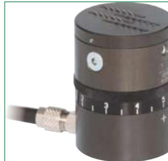
La profundidad del pinchazo se puede ajustar en menos de 1/10mm y es posible la instalación de una conexión adicional de aire para expulsar la pieza y su detección se realiza a través de detectores magnéticos que se integran en la carcasa de la pinza. Sommer estará en la feria BIEMH (Bilbao), en el
