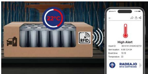
Las antenas y lectores RFID envían automáticamente una señal cada segundo a todas las etiquetas y sensores que se encuentran dentro de su rango y recogen las lecturas de la temperatura con una precisión de 0,5 °C. La plataforma de software RFID recoge todas las lecturas de temperatura y la ubicación en la que se encuentra cada batería. Cuando se alcanzan ciertos umbrales de temperatura definidos, la plataforma de software activa dispositivos de terceros a través de una API estándar.
