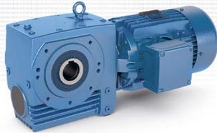
Las dimensiones de conexión no han cambiado, pero para implementar potencias más altas, Nord ha incorporado ejes sin fin con asientos de cojinetes mayores, así como un refuerzo adicional de la propia rueda helicoidal. La serie actual de reductores sin fin Unicase depara potencias de 0,12 kW a 15 kW y pares de entre 90 Nm y 3000 Nm.
