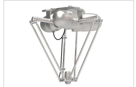
El DR-3iB/6 Stainless es un robot delta de acero inoxidable de Fanuc diseñado para ayudar a los clientes a maximizar la eficiencia en aplicaciones de picking y embalaje, concretamente de productos alimentarios, farmacéuticos y cosméticos.
