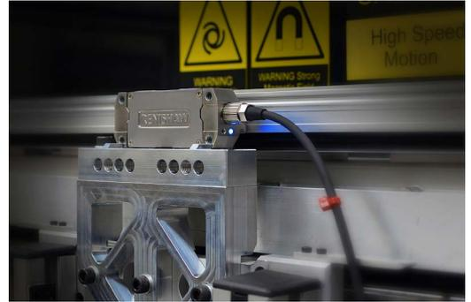
El cliente puede elegir entre dos perfiles de extrusión diferentes según sus requisitos de espacio. El encóder lineal FORTiS-S es el modelo de tamaño estándar, que se fabrica en longitudes de medición entre 140 y 3040 mm y se instala directamente en una superficie mecanizada a través de los orificios flexionados de la carcasa de extrusión.
