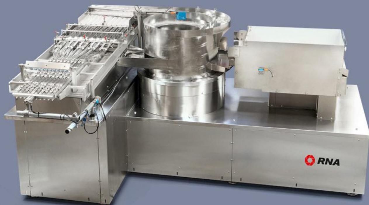
RNA Vibrant ofrece sistemas de alimentación multicanales, que permiten una gran flexibilidad de piezas y alta cadencia.
