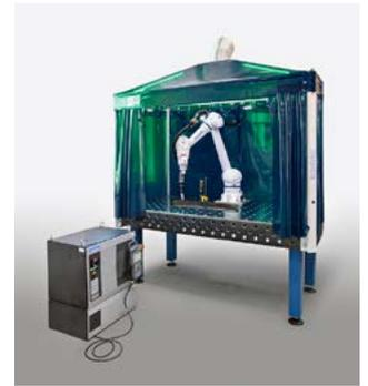
por Yaskawa, es una solución de soldadura colaborativa diseñada para facilitar la integración de la robótica en entornos industriales y mejorar la productividad de las operaciones de soldadura.
