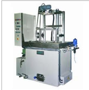
esto permite que durante el proceso de trabajo se pueda realizar un movimiento de agitación de la carga, consiguiendo de esta manera que el líquido penetre en las piezas y se acelere el proceso de limpieza total.
